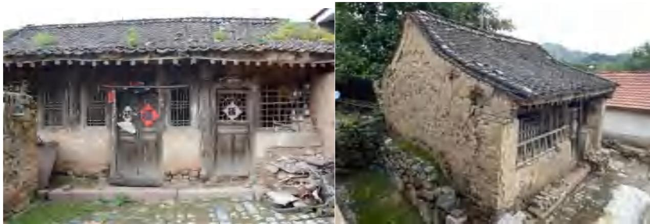
(7) 钟秋德院：钟秋德院坐北朝南，二进式四合院，正房面阔五间，二进东西厢房各三间，一进东西厢房各五间，南房二间，青瓦屋顶，双坡屋面的形制。面积为  $348 \text{ m}^2$ ，一层建筑，建筑结构形式为砖土木形式，建筑时期为清代，现状保存较好，墙体为砖土形式，屋顶为双坡面形式。
